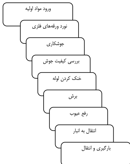
شکل ۱: مراحل تولید لوله‌های قطور فلزی.
