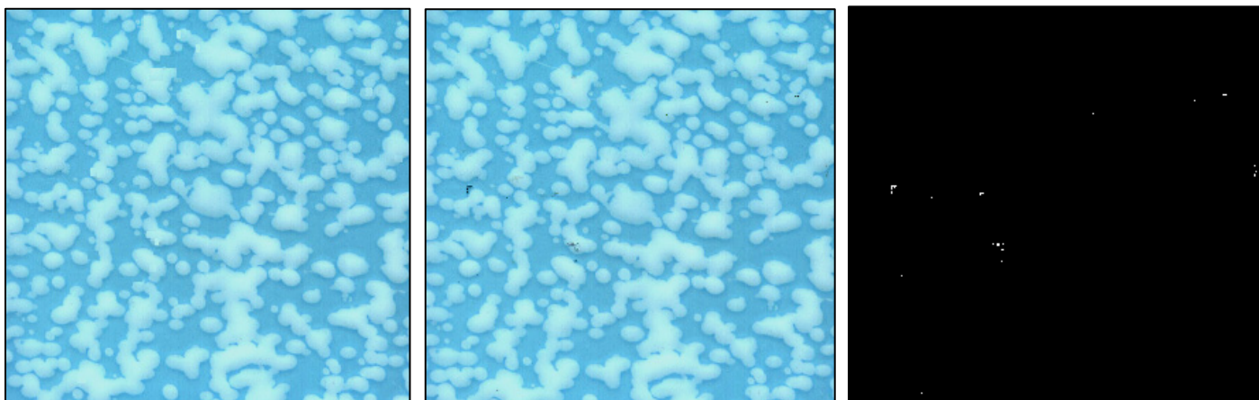
شکل ۵: (چپ) کاشی بدون عیب، (وسط) کاشی با عیوب رنگی، (راست) عیوب آشکار شده.
